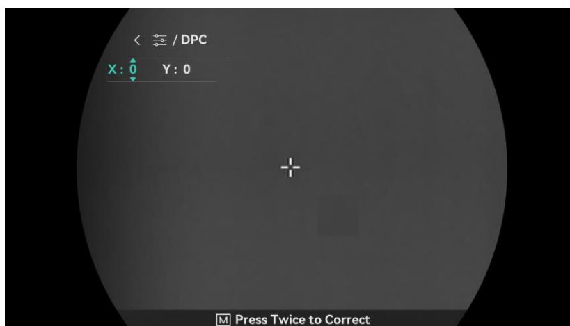
Obrázek 3-6 Oprava chybného pixelu
